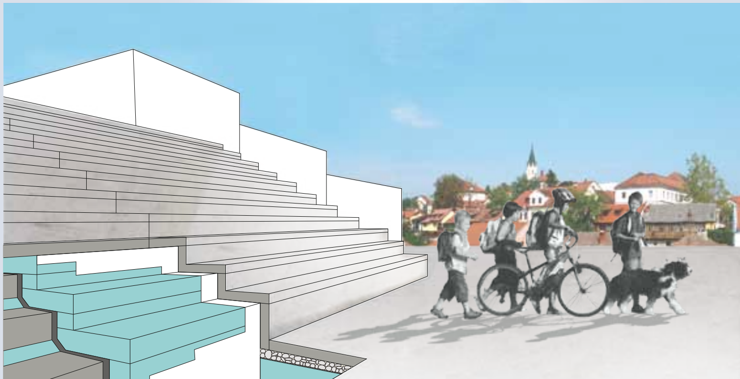
Трибуна за зрители като покрив на сграда, спортна площадка върху покрив
